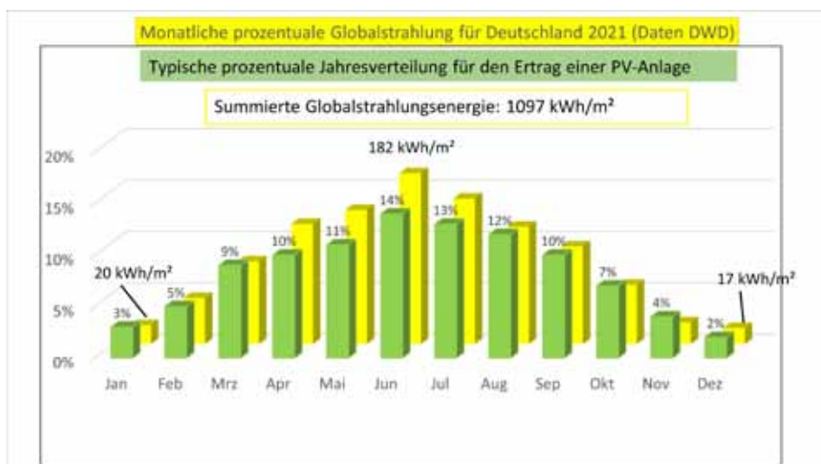
Bild 1: Es ist gut zu erkennen, dass in den Sommermonaten deutlich mehr Energie in Form von Globalstrahlung für die PV-Anlage zur Verfügung steht als im Winter (gelbe Balken); entsprechend verteilt sich auch der Solarertrag einer PV-Anlage (grüne Balken).
